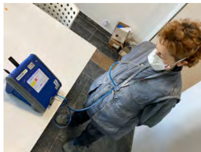
Fig. I.6. Trabajadora durante un test de ajuste cuantitativo por conteo de partículas (Fuente: INS)
